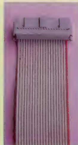
Lignes de connexion Les conducteurs du port utilisateur du Commodore 64.
